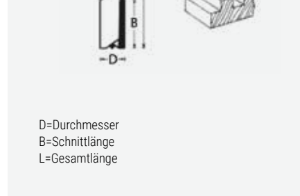
Artikel-Nr. Artikelbeschreibung 6040151 Langlochfräser zweischneidig Ø 8 mm, L=51 mm, B=19 mm 6040152 Langlochfräser zweischneidig Ø 10 mm, L=51 mm, B=19 mm 6040153 Langlochfräser zweischneidig Ø 12 mm, L=51 mm, B=19 mm 6040154 Langlochfräser zweischneidig Ø 14 mm, L=51 mm, B=19 mm 6040155 Langlochfräser zweischneidig Ø 16 mm, L=51 mm, B=19 mm 6040156 Langlochfräser zweischneidig Ø 12 mm länger, L=63 mm, B=32 mm ME Stück
