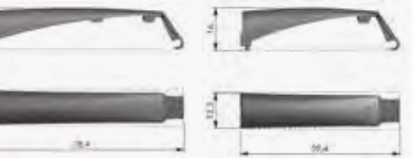
Auswerfergehäuse für den Kpush Auswerfer, weiß, l=20 mm
